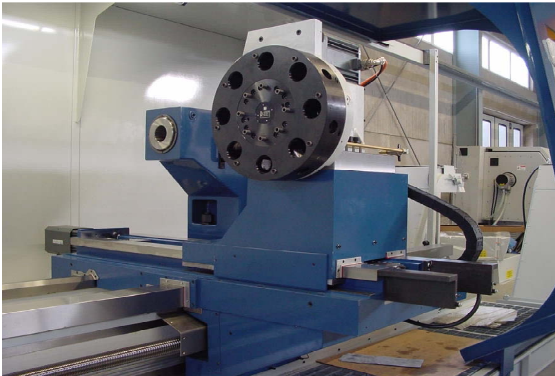
SAUTER 8-fach Werkzeugscheibe 0.5.901.025/473 / VDI 50 oder VDI 60
